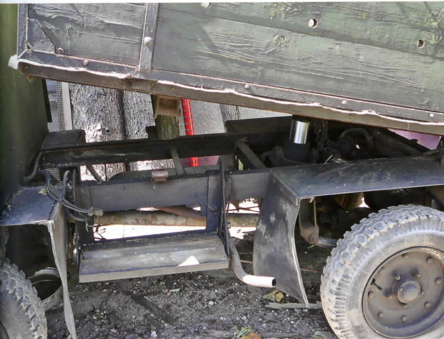
Die Hydraulik für den Kipper ist wartungsfrei. Sie hebt noch heute schwerste Lasten.
