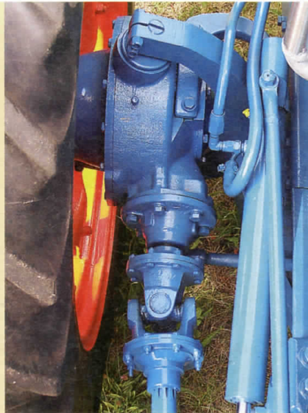
Die Technik, die anderen Allradtraktoren für die gesamte Vorderachse reicht, hat der County-Umbau pro Seite vorzuweisen
