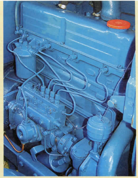
Simms-Reiheneinspritzpumpe: Erst ab 1962 kam die Einspritzung von Minimax, auf dem Gehäuse stand aber weiterhin „Simms“
