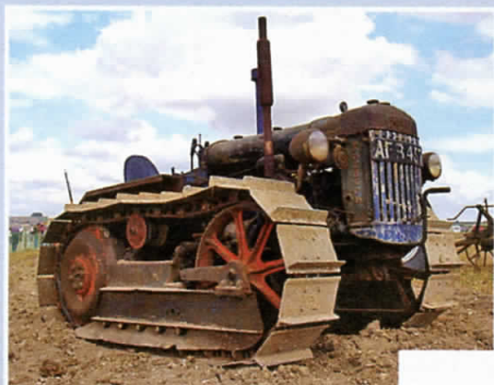
Die ersten Raupenschlepper von County entstanden 1948 auf Fordson E 27 N-Basis mit Benzin-/Petroleummotor. Danach folgten auch Ausführungen mit Perkins-Sechszylinderdiesel
