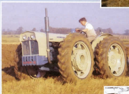
Das Bild aus dem Jahr 1963 zeigt den County Super Six mit dem Sechszylindermotor 590 E von Ford. Das Fahrzeug basiert ebenfalls auf einen Super Major
