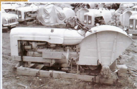
Das Bild aus dem Jahr 1963 zeigt den County Super Six mit dem Sechszylindermotor 590 E von Ford. Das Fahrzeug basiert ebenfalls auf einen Super Major
