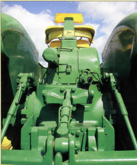
Gewichtheber: Die Hubkraft der Hydraulik beträgt stolze zwei Tonnen. Wird keine Leistung benötigt, schaltet sich die Pumpe ab
