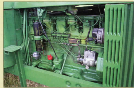
Wartungsbereich: Auf der rechten Seite sitzen Kraftstofffilter, Lichtmaschine, Ölstützen und Einspritzpumpe
