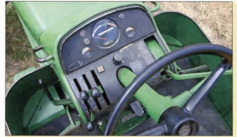
Kommandostand: Die Hydraulik wird mit drei Hebeln auf der Instrumentenkonsole geregelt, der Gangwahlhebel sitzt rechts
