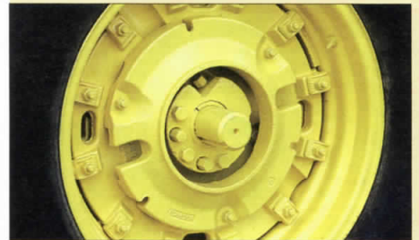
An die Räder lassen sich bei Bedarf ab Werk lieferbare Zusatzgewichte, Greifer oder Doppelbereifung montieren
